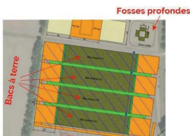
Bacs à sol de grandes dimensions (taux d'argile 7 %, 10 %, 25 %, 70 %) pour tests pneumatiques, véhicules, semoirs...
